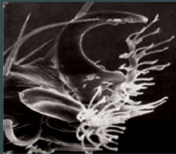
شکل ۱۷- اثر کاهش ولتاژ در کاهش شارژ الکتريکی در تصویرگیری نمونه پای ملخ، الف) نمونه بدون شارژ الکتريکی و ب) نمونه با شارژ الکتريکی [۹].
