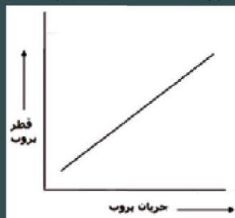
شکل ۱۱- ارتباط بین جریان باریکه الکترونی و قطر آن [۱۰]
