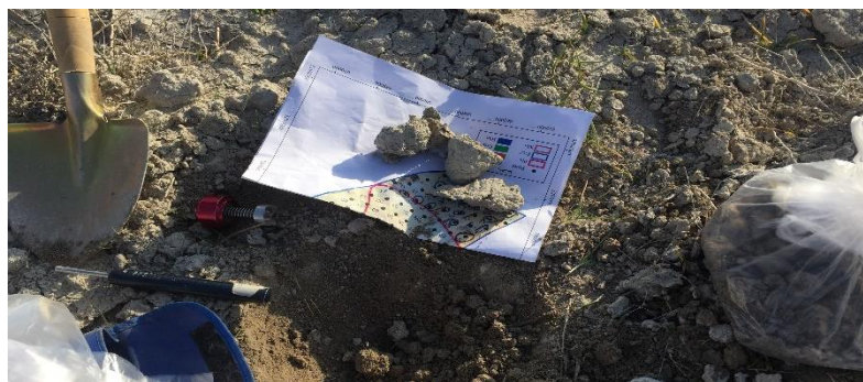
شکل ۲- نمایی از دستگاه‌های نفوذسنج دستی و مقاومت‌سنج برش پره‌ای مورد استفاده و یکی از نقاط نمونه‌برداری حین عملیات میدانی
