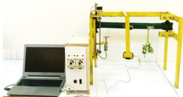
شکل ۳- سامانه ساخته شده در پژوهش برای برش دقیق سبزی‌های خوراکی
