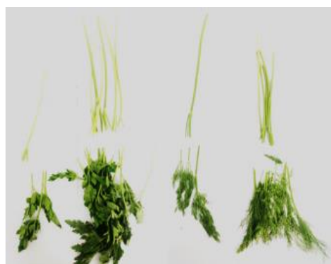
شکل ۶- نمونه کیفیت جدا کردن مکانیزه قسمت برگی از ساقه محصول جعفری و شوید با دستگاه طراحی شده
