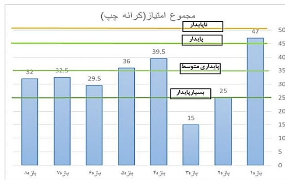
شکل ۱۱. وضعیت پایداری کانال در بازه‌های تحت مطالعه در رودخانه حاجی عرب با استفاده از شاخص پتانسیل فرسایش کانال در کرانه چپ
