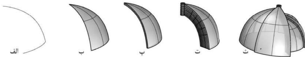
شکل ۱. الف. قوس های پایه، ب. پوسته ی ابتدایی، پ. ضخامت دهی به پوسته، ت. تکثیر و مقیاس دهی در حالت جمع شده به همراه تولید فرم پین بزرگ و ث. خروجی دوران یافته از الگوریتم نوشته شده در Grasshopper
