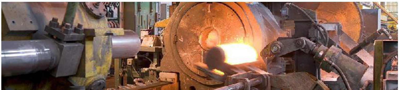
شکل ۲- تغییر شکل فلزات توسط فرایند اکستروژن گرم
