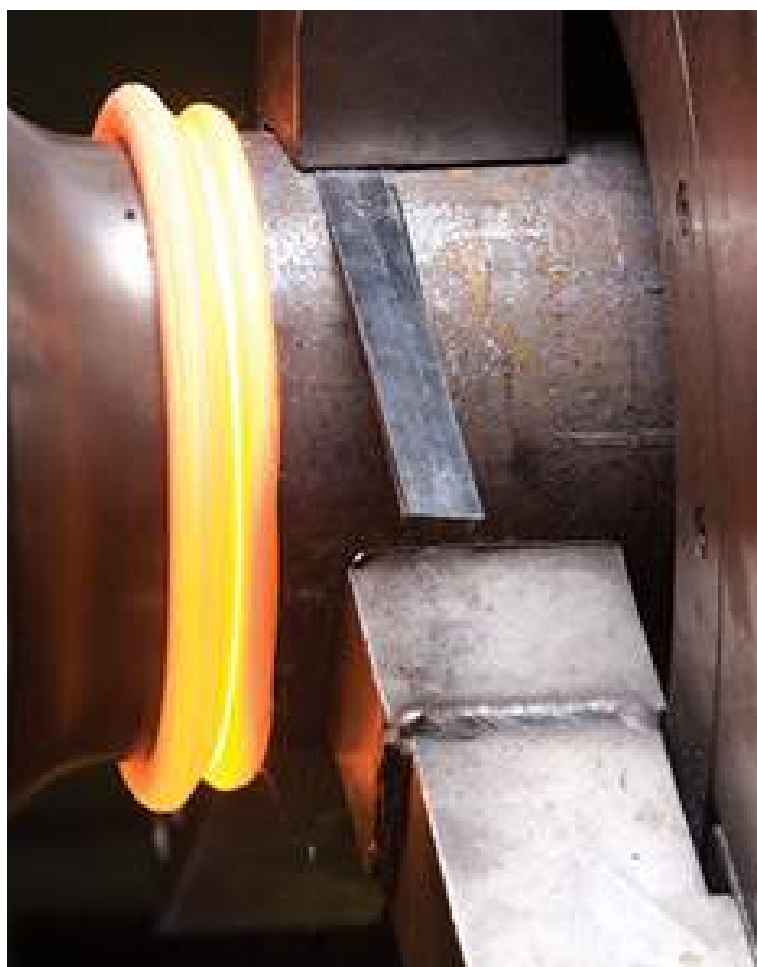
شکل ۳- روش جوشکاری اصطکاکی، از روش‌های جوشکاری غیرذوبی
