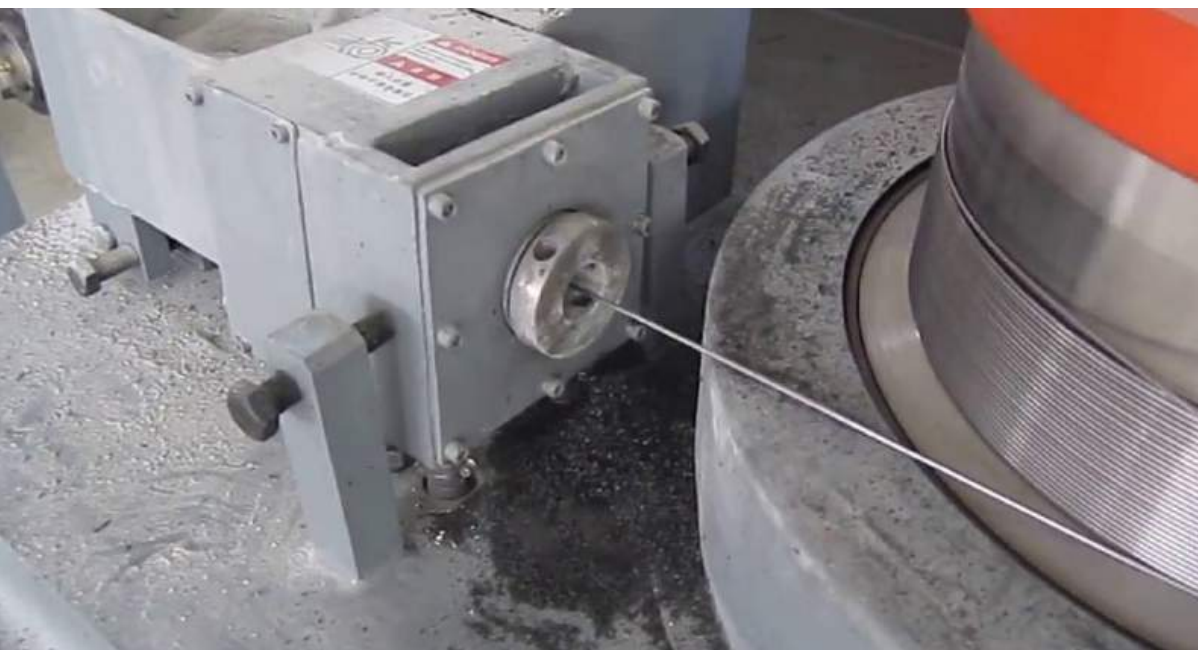
شکل ۷- تغییر شکل فلزات توسط فرایند کشش سیم
