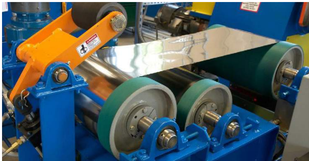
شکل ۵ - تغییر شکل فلزات توسط فرایند نورد سرد
