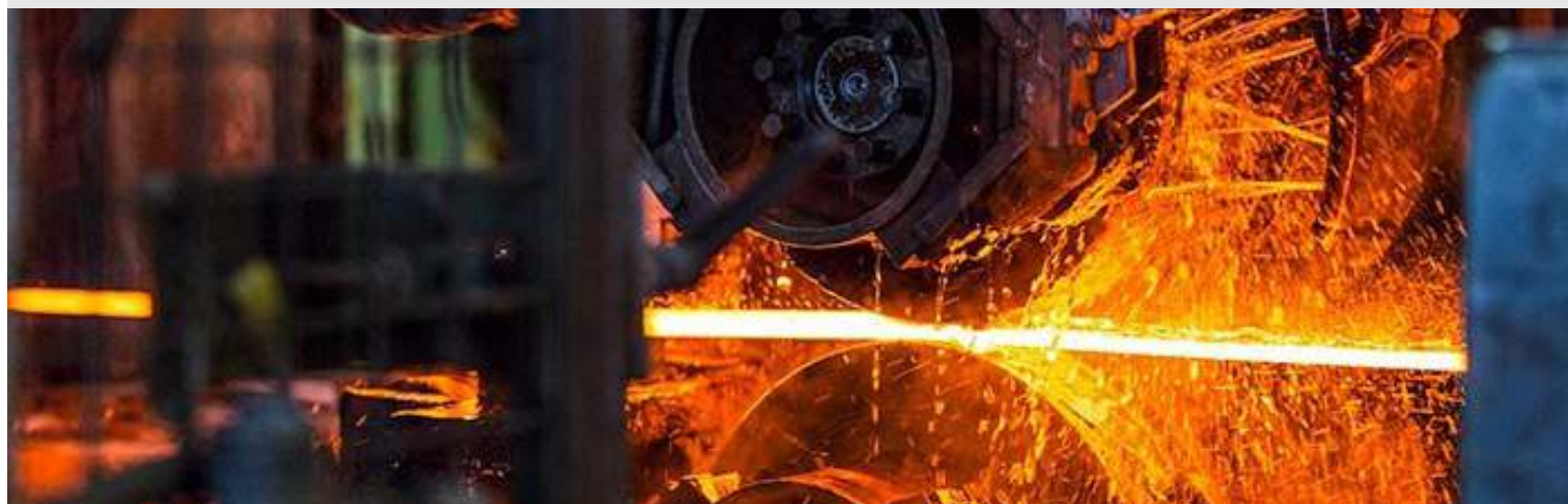
شکل ۴ - تغییر شکل فلزات توسط فرایند نورد گرم
