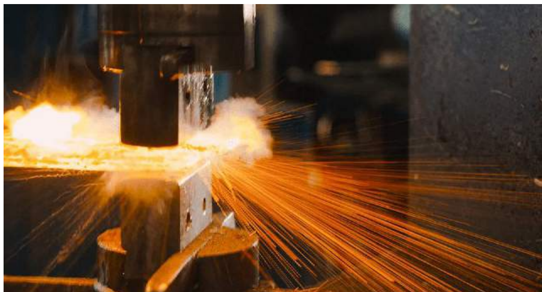
شکل ۶ - تغییر شکل فلزات توسط فرایند آهن‌گری
