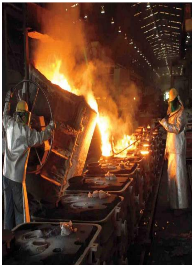
شکل ۲- ریخته‌گری فلز مذاب در قالب
