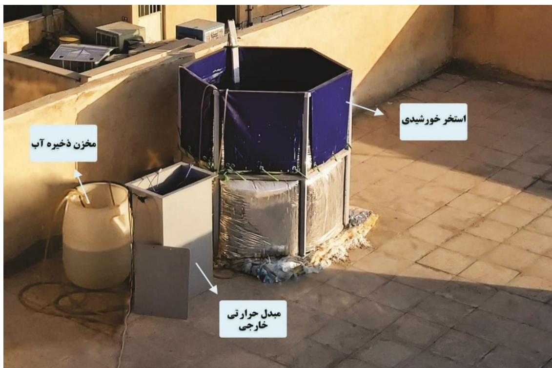
شکل ۳- سامانه استخر خورشیدی استفاده شده در این تحقیق و بخش‌های مختلف آن
