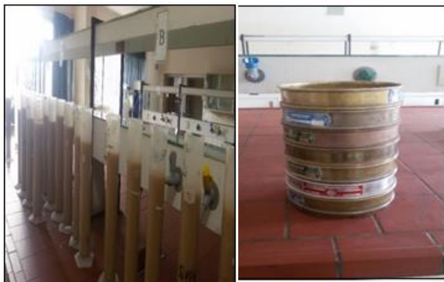
شکل ۲- سری الک‌ها (۲، ۱/۱۸، ۰/۶، ۰/۲۵، ۰/۰۵) برای جداسازی ذرات شن (الف) و آزمایش هیدرومتر برای تعیین دانه‌بندی ذرات ریز (ب)
