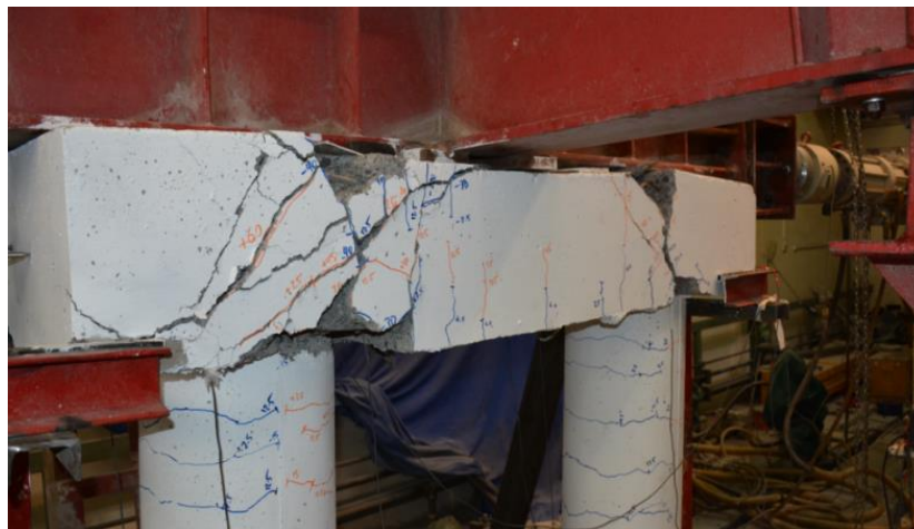
Fig. 27. Failure mode of SP-80
