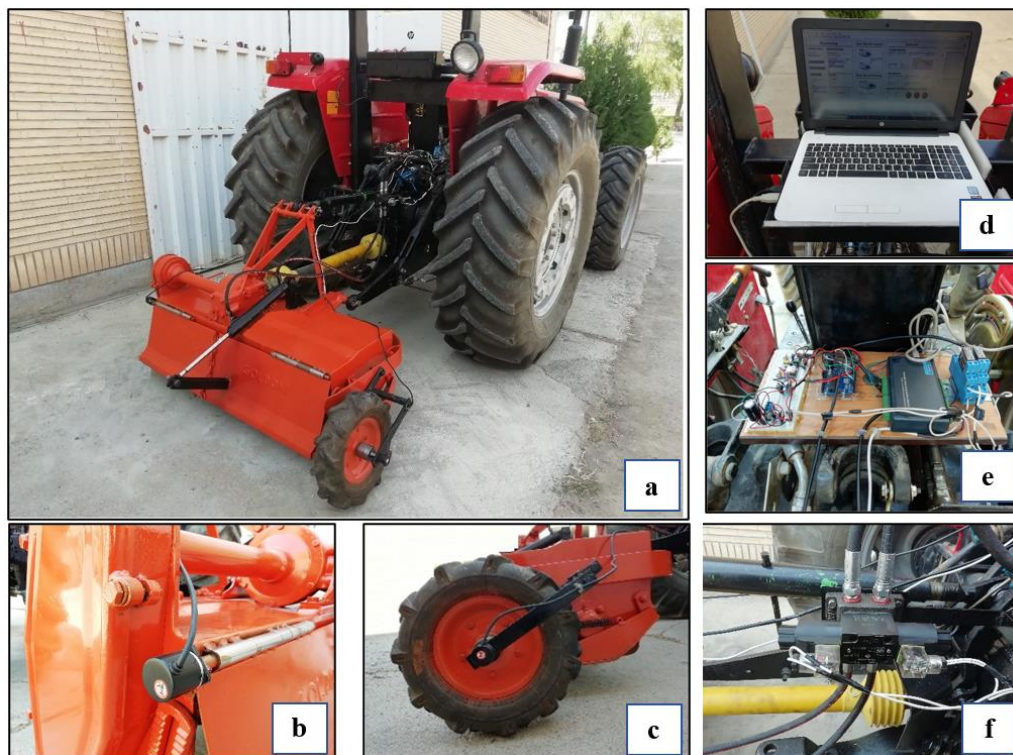
شکل ۲- سامانه کنترل موقعیت حفاظ خاک پیاده سازی شده روی یک روتیواتور گلدونی (مدل C40). (a) ترکیب تراکتور-روتیواتور، (b) اینکودر حفاظ خاک، (c) اینکودر چرخ زمین گرد، (d) رایانه همراه، (e) سامانه انتقال داده و (f) شیر کنترل جهت سلونوئیدی
