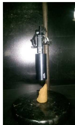
شکل ۴. اندازه‌گیری طیفی نمونه تک‌محوری پس از آزمایش مقاومت تک‌محوری
