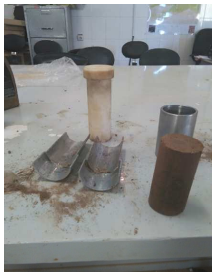
شکل ۲. ساخت نمونه خاک برای اجرای آزمایش تک‌محوری
