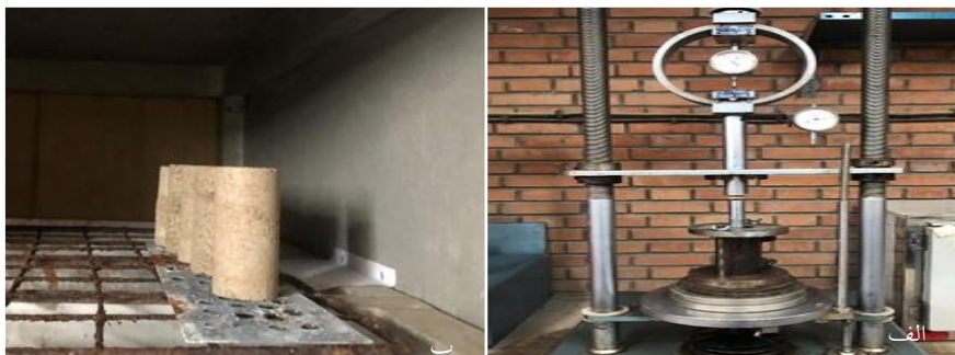
شکل ۲. الف) نحوه قرارگیری نمونه‌ها درون قالب (ب) نمونه‌های قرار گرفته درون محفظه مخصوص
