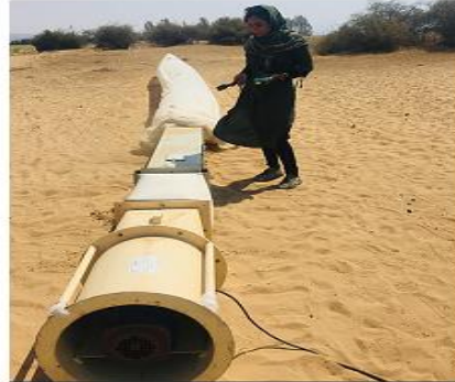
شکل ۲. تصویر دستگاه تونل باد و استفاده از آن در صحرا
