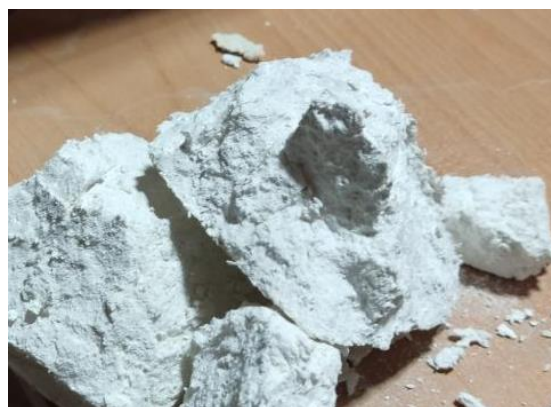
شکل ۳. نمونه حاوی الیاف رنگبری نشده، لیگنوسولفانات، کربنات کلسیم اصلاح‌شده، نشاسته تاپیوکا و پلی‌ونیل الکل بعد از شکست
