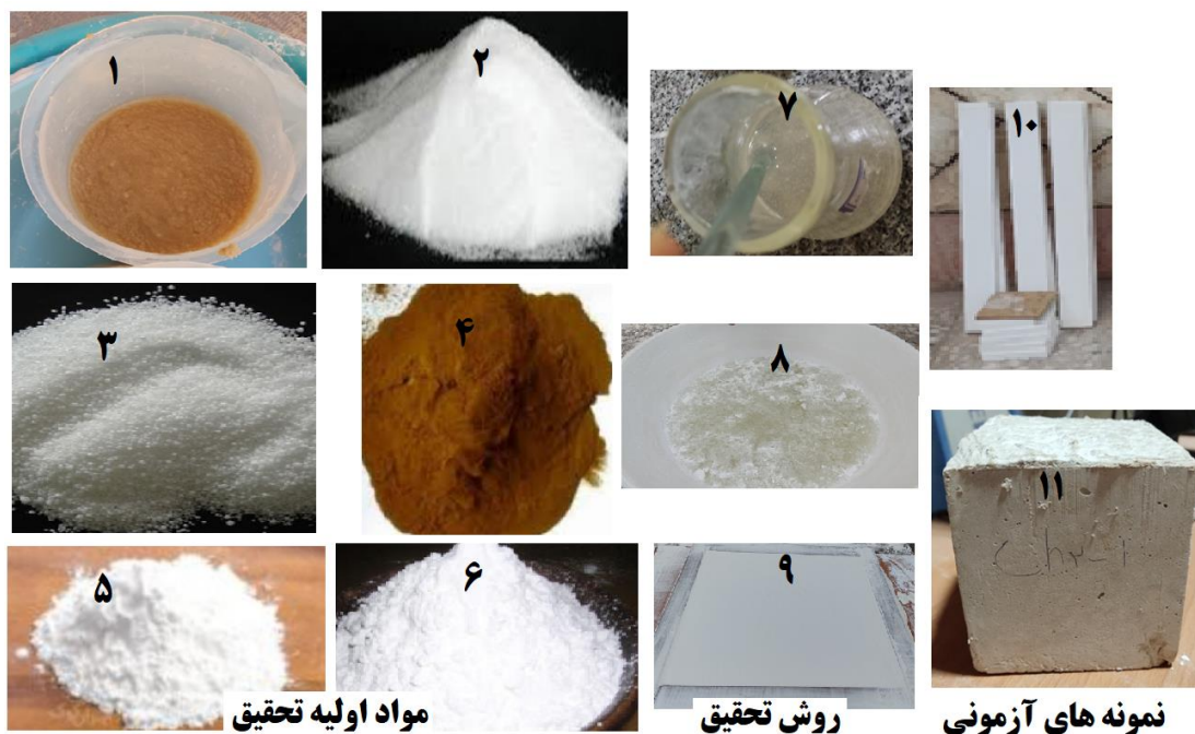
شکل ۱. مراحل ساخت نمونه‌های تیمارها ۱- الیاف رنگبری نشده، ۲- پلی‌ونیل الکل، ۳- اسید استتاریک، ۴- لیگنوسولفانات، ۵- نشاسته ذرت، ۶- نشاسته تاپوکا، ۷- پخت نشاسته، ۸- کربنات کلسیم اصلاح شده، ۹- قالب‌گیری گچ‌برگ، ۱۰- نمونه‌های آزمون مقاومت خمشی، چگالی و جذب آب و ۱۱- نمونه آزمون مقاومت فشاری.
