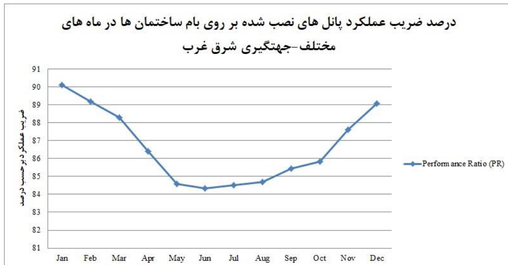
شکل ۸. ضریب عملکرد پانل‌های نصب‌شده در ماه‌های مختلف سال با جهت‌گیری شرق- غرب خروجی نرم‌افزار PVSol
