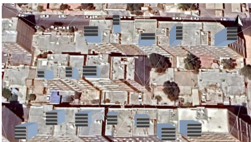
شکل ۶. نمای بالا از شبیه‌سازی نصب پانل روی بام ساختمان خروجی از نرم‌افزار PVSol
