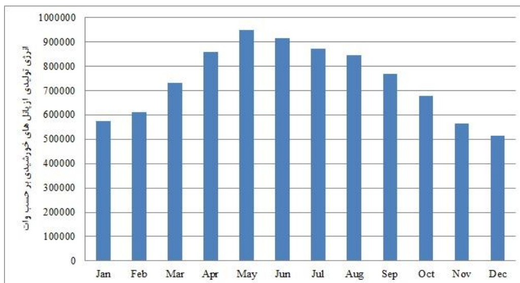
شکل ۱۰. انرژی تولیدی ماهیانه از پانل‌های نصب‌شده در جهت‌گیری جنوب‌سوی خروجی نرم‌افزار PVSol
