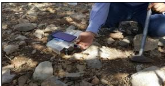
شکل ۲. نصب پایه های ثابت برای استقرار دوربین در زیر تاج درخت (راست) و نصب صفحه متحرک و تنظیم محل قرارگیری آن به کمک نور لیزر و نشانه روی تنه درخت (چپ)
