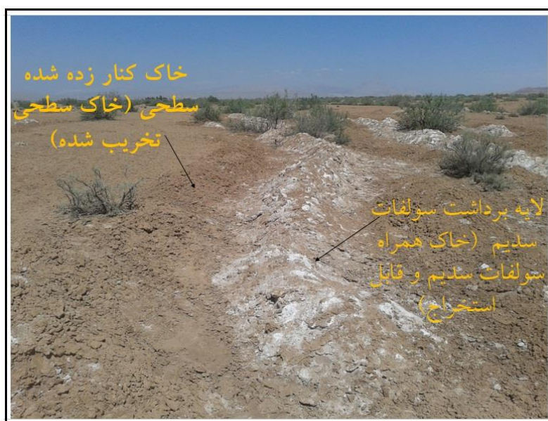
شکل ۳. مورفولوژی سطوح تحت برداشت سولفات سدیم
