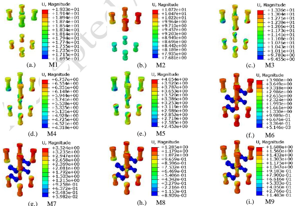
Fig. 18. Bolts displacement
