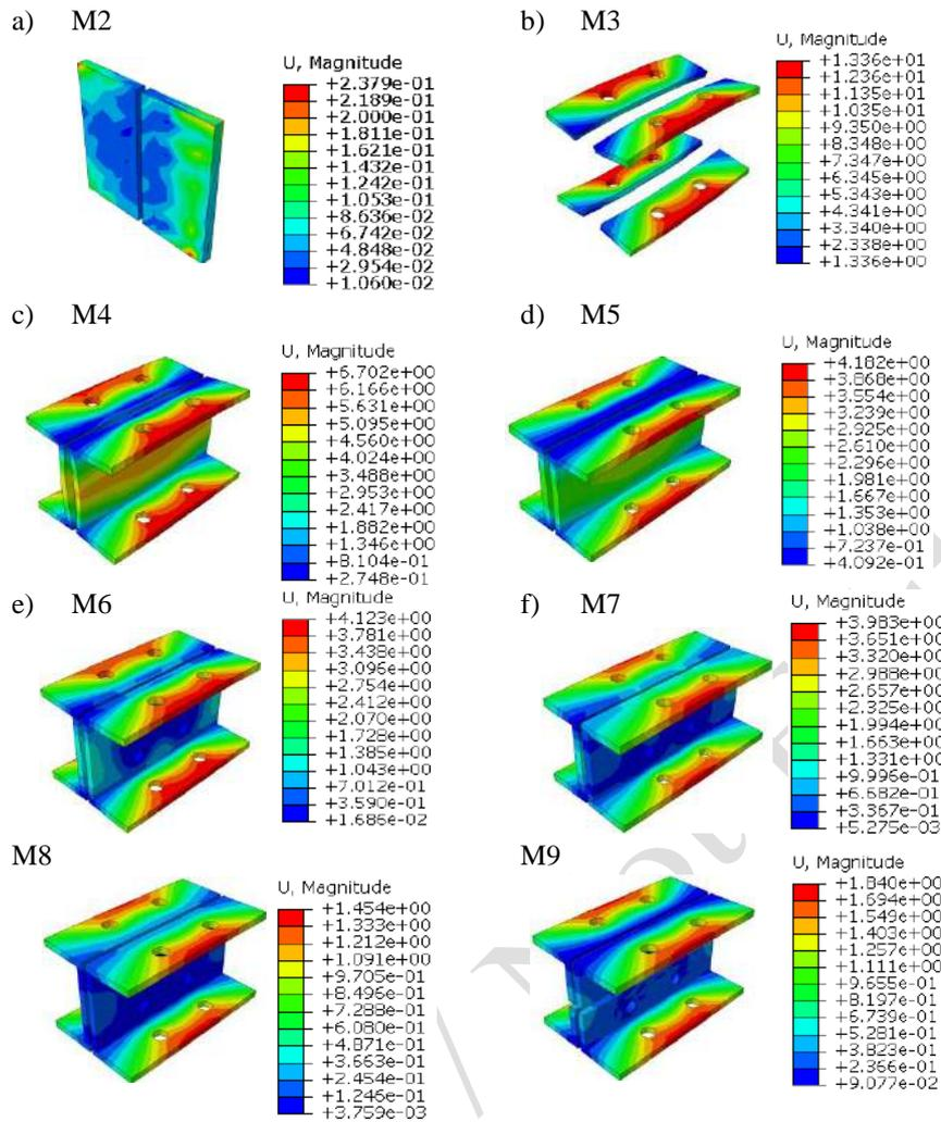
Fig. 15. Stiffeners displacement
