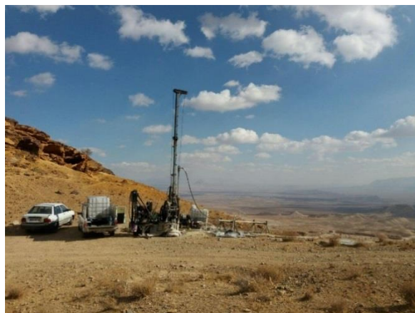
شکل ۵. نمای از دستگاه حفاری مورد استفاده برای حفر گمانه‌های حرارت‌سنجی در منطقه محلات
