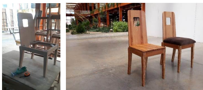
شکل ۵. صندلی با پشتی قوس‌دار ساخته شده از اسکریمبر کامپوزیت حاصل از روکش و لایه‌های چوبی دورریز
