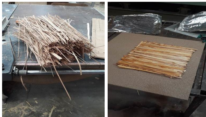
شکل ۱. ساخت نشیمنگاه صندلی از اسکریمر کامپوزیت‌های مسطح
