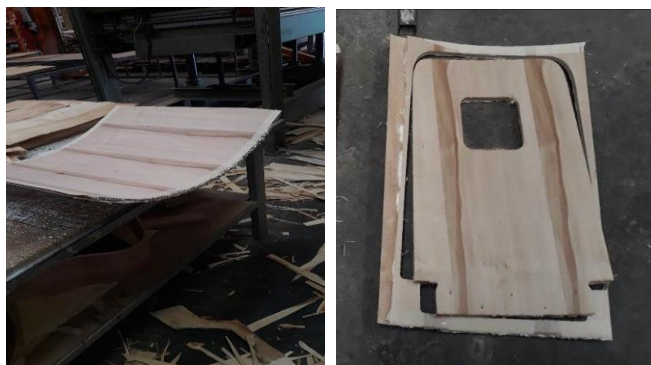
شکل ۲. ساخت پشتی صندلی به صورت قوس‌دار
