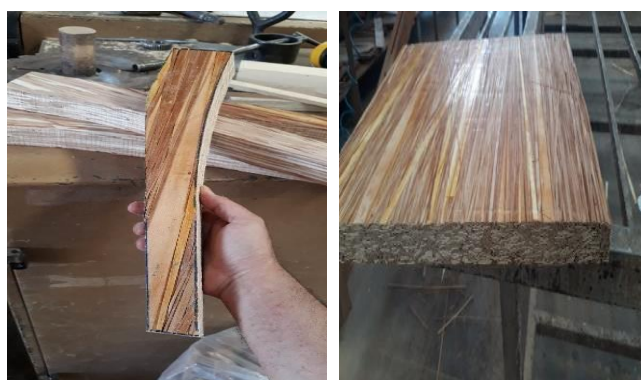
شکل ۳. ساخت پایه‌های صندلی از اسکریمبر کامپوزیت‌های با ضخامت ۵ سانتی‌متر و برش با شابلون پایه
